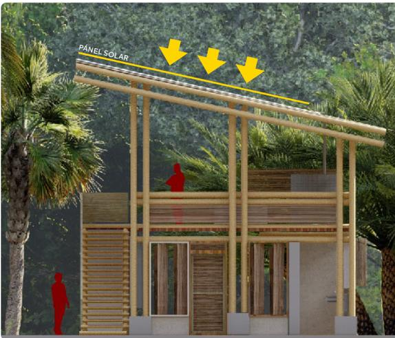
▶ La gran superficie de cubierta permite acoplar sistemas de recolección de aguas lluvias y energía solar.
