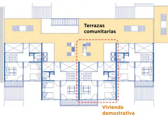
■ Planta del segundo piso de una célula (4 viviendas) en el que se comparte la terraza.
