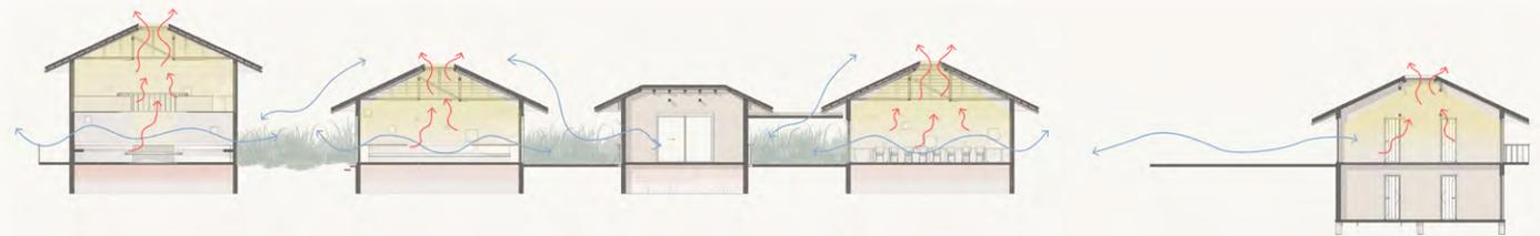
Sistema bioclimático: con la orientación según el viento o el sol, la óptima disposición y tamaño de ventanas abatibles y puertas hacia patios y los óculos de las cubiertas se obtienen iluminación y ventilación natural y confort térmico.
