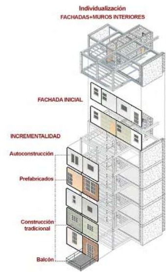
La construcción deja en el perímetro módulos estructurales sin construir para que los usuarios los finalicen según sus necesidades y recursos.
