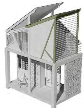
Opciones del techo móvil para adaptar los espacios interiores al crecimiento de la unidad.
