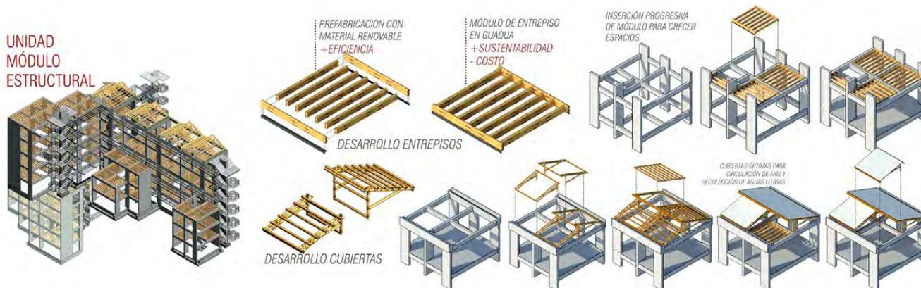
Esquema estructural y constructivo. Se utiliza la guadua para entrepisos y cubiertas.
