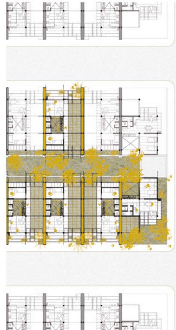
Planta urbana. La manzana está conformada por dos hileras de casas que comparten los jardines posteriores (sin divisiones), lo que permite la salida del aire caliente a través del centro de manzana. Las viviendas de los extremos tienen un diseño diferente.
