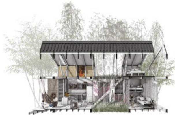
Corte perspectiva longitudinal con ampliación en el segundo piso
