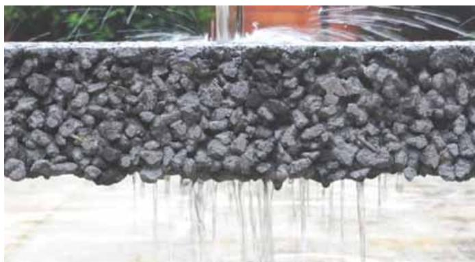
■ Demostración de la filtración del agua a través del concreto. Con el Bio-creto, el área activa de infiltración del agua es toda la vía, mientras que en los sistemas actuales es por las alcantarillas, que fácilmente se pueden taponar.
