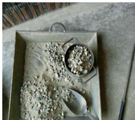
Los escombros son residuos inertes provenientes de distintas actividades de la construcción; están compuestos por 20% de hormigón, 50% de material de albañilería (cerámico, tubería, uniones, etc.), 10% de asfalto y 20% de otros elementos como maderas. La limalla proviene en su mayoría del maquinado de motores de combustión y en general de las actividades de la industria metalmeccánica, de modo que sus características pueden variar de una industria a otra.
