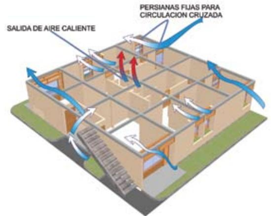
Esquema de funcionamiento bioclimático ▲
